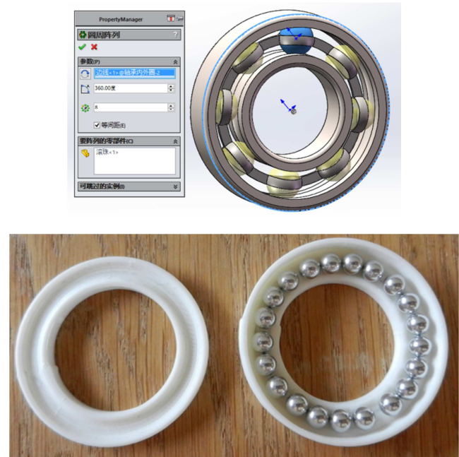
图3 轴承三维建模与3D打印模型。
