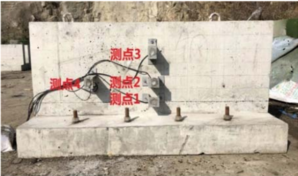
图3 超压测点布置图。
