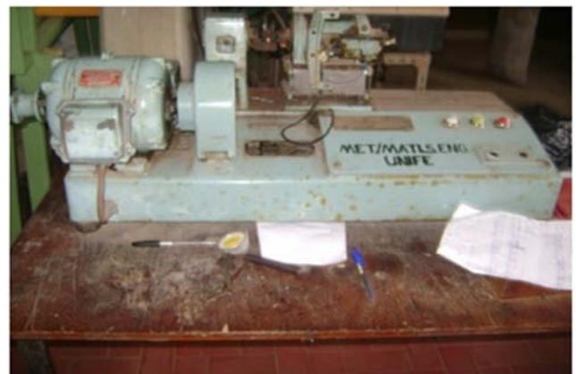
Fig. 1. Fatigue testing Machine (Avery Model 7305).
